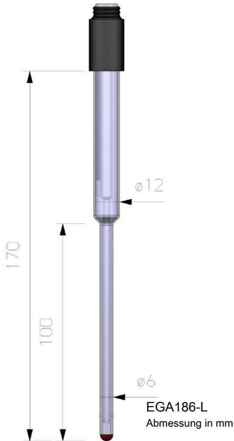
Diese pH-Einstabmesskette eignet sich besonders für Messungen in sehr kleinen Volumina. Das nachfüllbare Bezugselktrodensystem erfordert ein regelmäßiges Nachfüllen des Elektrolyten und ermöglicht den drucklosen Einsatz insbesondere im Labor.
